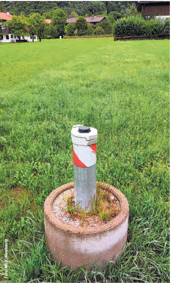
Mit Hilfe zahlreicher solcher Messstellen wurde im Rahmen der Studie festgestellt, dass die Temperatur des Grundwassers steigt.
